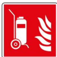
Estintore antincendio carrellato
